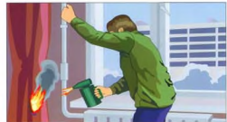
Отсутствие заземления труб газовых котлов и форсунок
